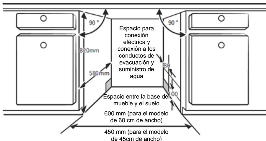
2. Si el lavavajillas se instala cerca de una esquina, deje una distancia de seguridad para abrir la puerta.
