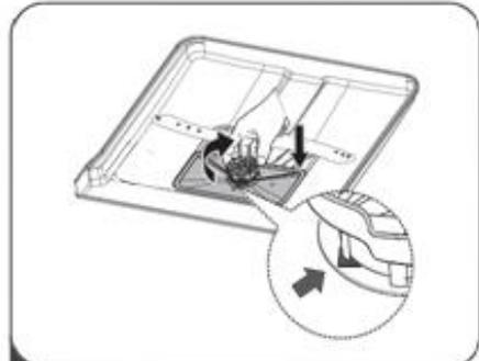
**4** Vuelva a montar los filtros siguiendo los pasos de desmontaje en orden inverso; reemplace el dispositivo de filtrado y gírelo en sentido horario hasta la flecha de cierre.
