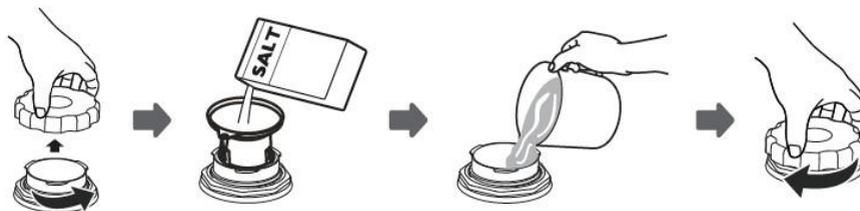
1. Retire la bandeja inferior, afloje y retire la tapa del depósito de sal.
