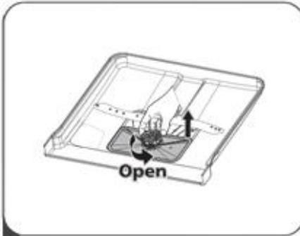
**1** Coja el filtro primario y gírelo en sentido antihorario para desbloquearlo. Levante el filtro y sáquelo del lavavajillas.
