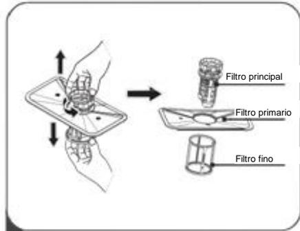
**2** Puede quitar el filtro fino situado en la parte inferior del dispositivo de filtrado. Retire el filtro primario del filtro principal presionando suavemente las lengüetas de la parte superior antes de quitar el filtro.
