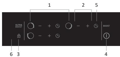
1. Commandes de sélection des zones de chauffage
