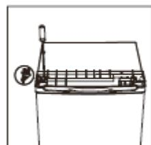
11. Coloque la cubierta superior y fíjela con 2 tornillos en la parte trasera.
